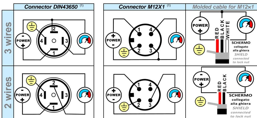
(1) La regolazione dello ZERO è accessibile svitando la ghiera / ZERO adjustment is accessible by unscrewing the nut.
